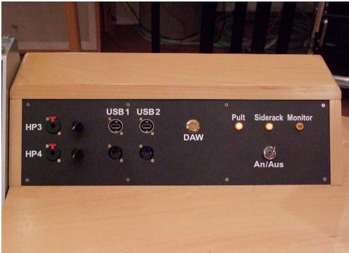
Abb. 3: Bedientableau mit Schlüsselschalter und Druckknopf zum Start des DAW-Computers. Die Leuchten zeigen die Aktivierung der Einschaltstufen gemäß Schaltsequenz an.
